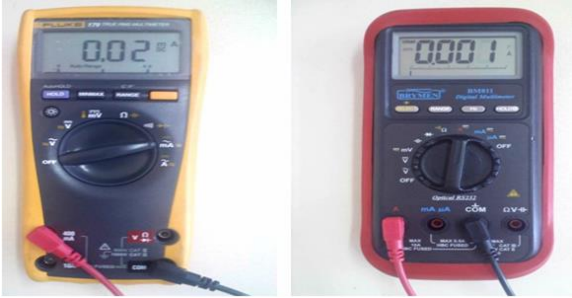
Şekil.10 DC mili-ampere ve DC amper ölçümü için hazırlanmış multimetreler
