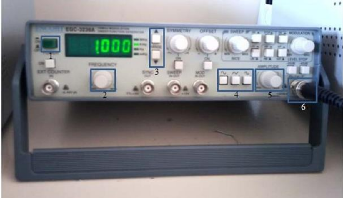
řekil.12 -Elektrik devre laboratuvarında kullanılan sinyal reteci.
